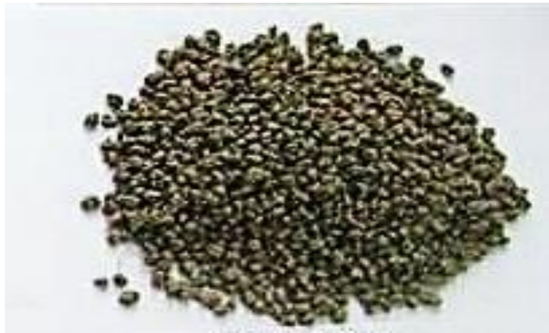
Рис. 8. Оплавленные неорганические гранулы грунта фракцией 1–2 мм
