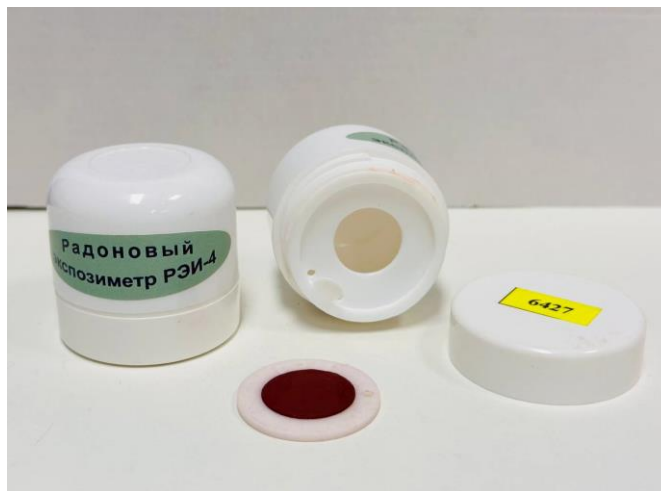
Рис. 1. Радоновый экспозиметр «РЭИ-4» с трековым детектором LR-115
