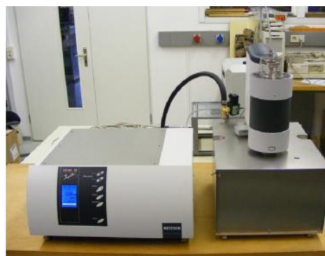
Рис. 2. Совмещенный термоанализатор STA F3 Jupiter для методов ТГА/ДСК
