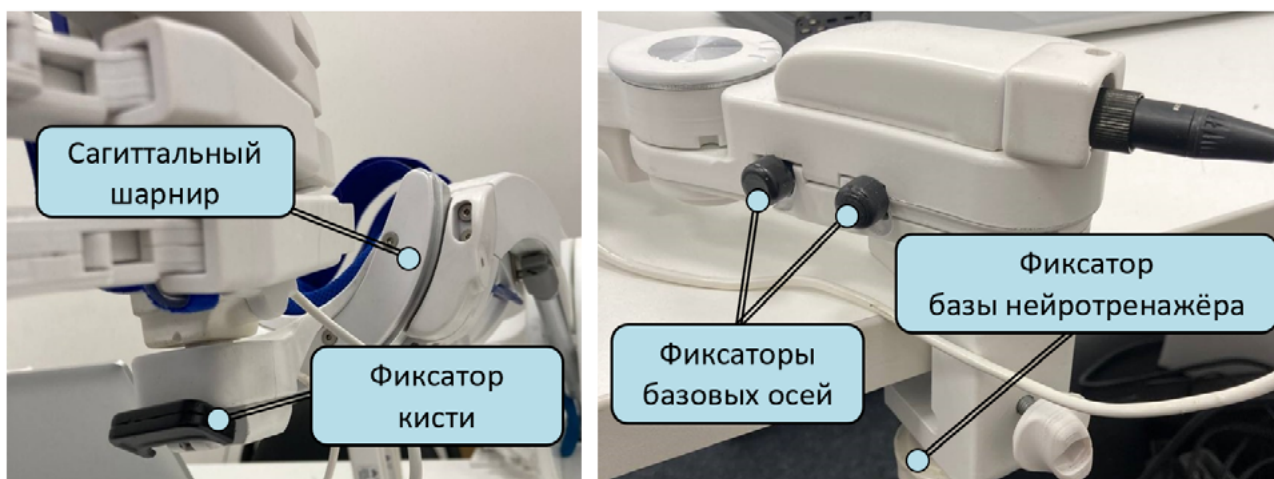
Рис. 3. Расположение основных фиксаторов нейротренажера для блокировки пассивных степеней свободы
