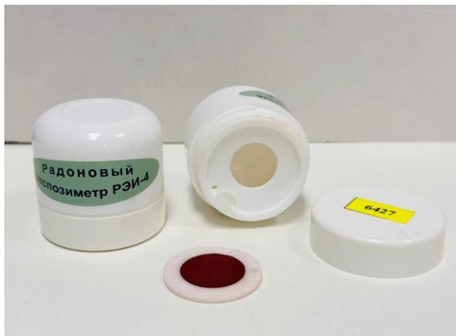
Рис. 1. Радоновый экспозиметр «РЭИ-4» с трековым детектором LR-115
