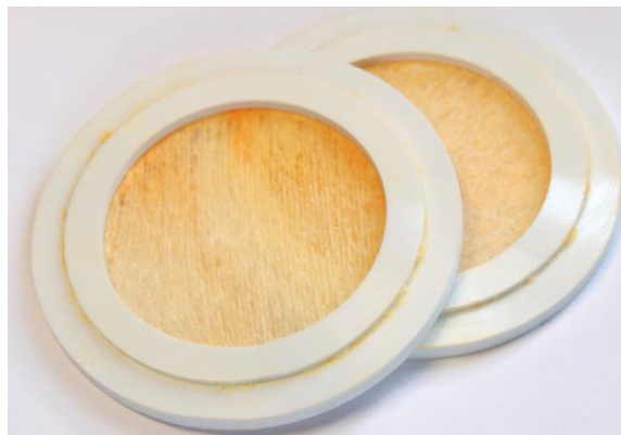
Рис. 3. Картридж с хемосенсорным веществом
