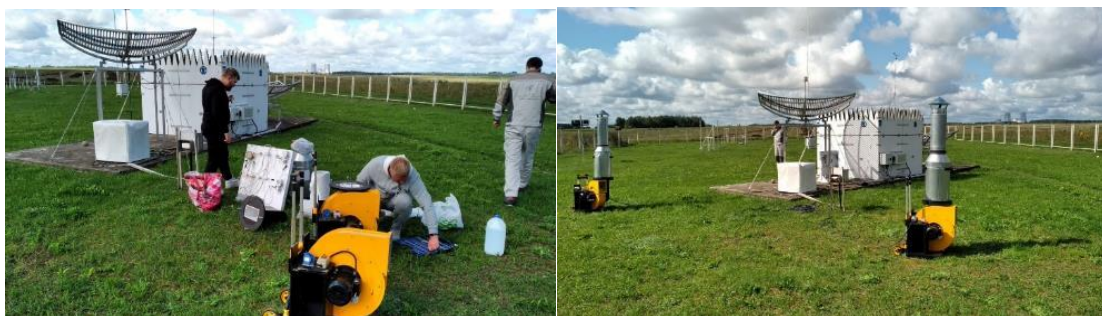
Рис. 7. Сбор и установка воздухофильтрующей установки (ВФУ-1200) и пробоотборного стенда для углерода и трития
