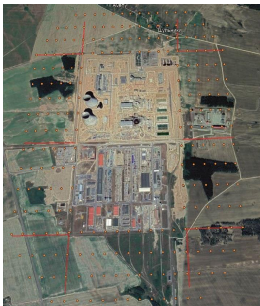
Рис. 5. Точки полевой гамма-спектрометрической съемки
