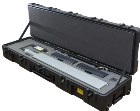
Рис. 3. Мобильный комплекс радиационного сканирования МКС АТ6103
