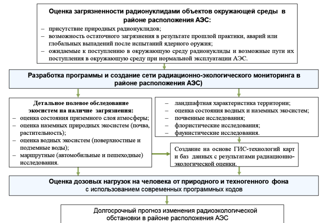
Рис. 1. Алгоритм проведения предэксплуатационной радиоэкологической оценки состояния окружающей среды
