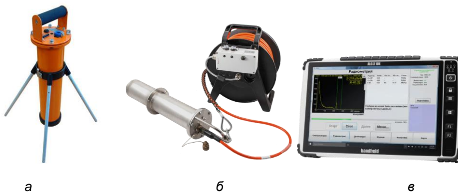
Рис. 2. Средства измерения для проведения исследования in situ: а – МКС-АТ6101ДР, б – МКС-АТ6104ДМ, в – БОИ
