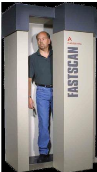
Рис. 12. Наиболее распространенный в мире WBC типа FastScan-2250 (Canberra Ind., USA)
