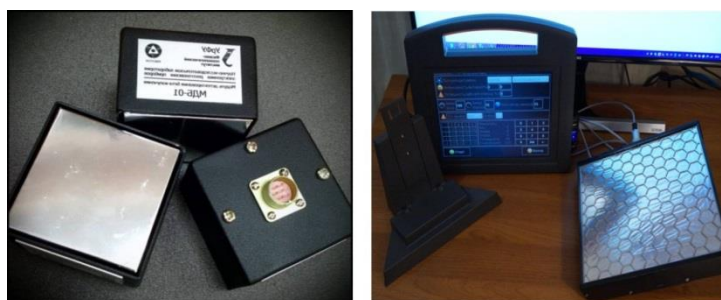
Рис. 11. Отдельные детектирующие ячейки размером 50 \cdot 50 \cdot 10 мм (слева) и радиометр РЗС-21 с БДБ-107 с 16 ячейками (справа)
