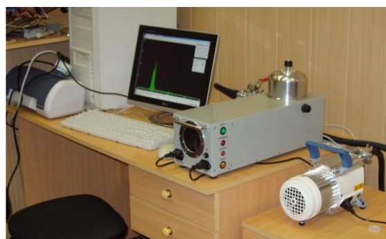
Рис. 6. Настольный EDXRF-анализатор «Старт-01» с вакуумированием исследуемого образца
