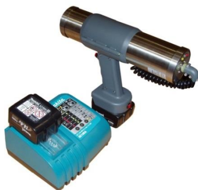
Рис. 9. Интеллектуальный детектор «Старк-01» с кристаллом LaBr_3:Ce , \eta_{662\text{keV}} \leq 3,0\% . Слева зарядное устройство с подключенным аккумулятором
