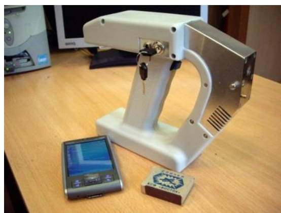
Рис. 5. Портативный EDXRF-анализатор MAPФ-03/вм. Кремниевый SDD Amptek, XPT Moxtek и промышленный карманный персональный компьютер
