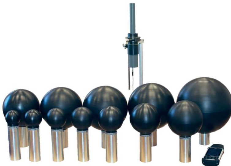
Рис. 1. Мультисферный дозиметр-радиометр МКС-АТ1117М с БДКН-06 и полиэтиленовыми сферами-замедлителями
