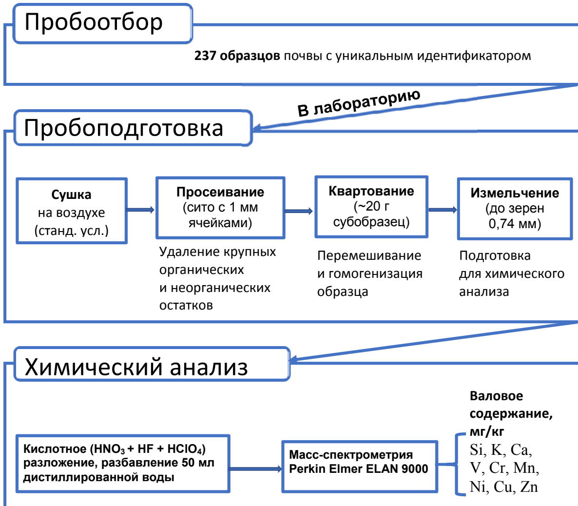
Рис. 2. Этапы пробоподготовки и химического анализа
