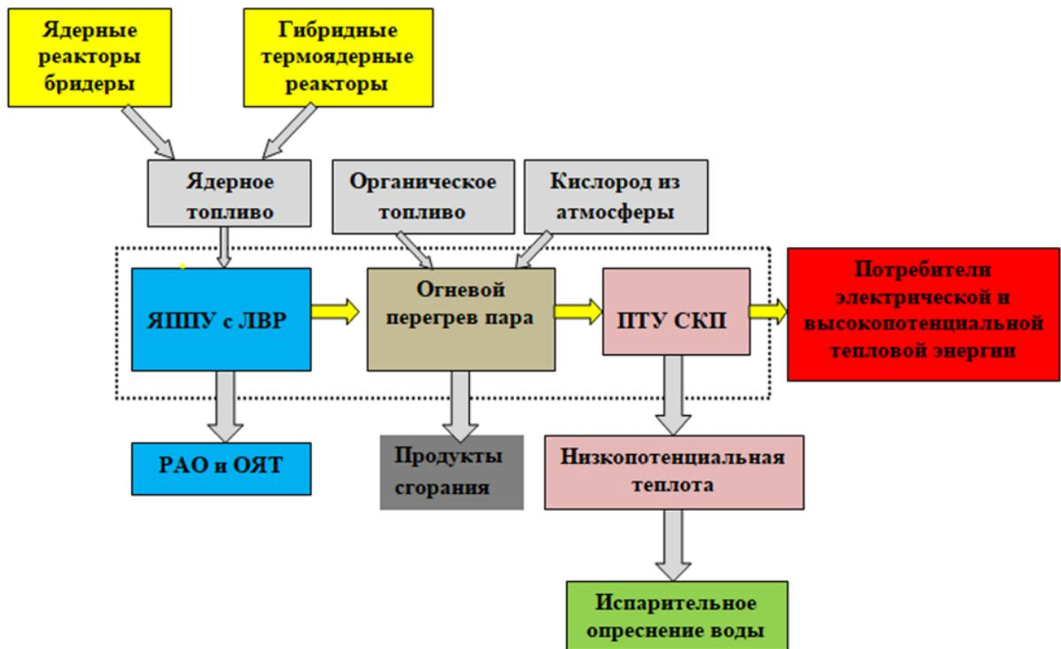
Рисунок 1. Схема энергетической системы гибридного типа
